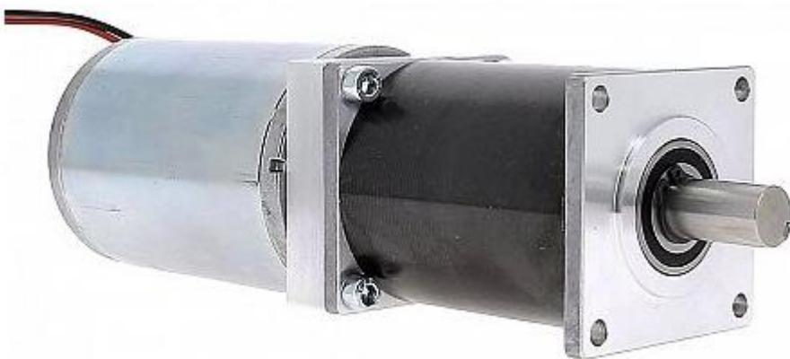
Réducteur planétaire à haute endurance pour lourde charge de travail continue dans n'importe quelle position, température de -20 à 65 ° C, avec un couple de charge jusqu'à 35 Nm, charge constante. Boîte en acier. Fixation frontale par quatre trous Ø5,1. Ensemble de vitesse. Engrenages en acier trempé garantissant une excellente durée de vie. Arbre de sortie. Ø12,7 mm. Arbre en acier inoxydable, utilisable 25 mm longueur, avec une rainure de clavette
