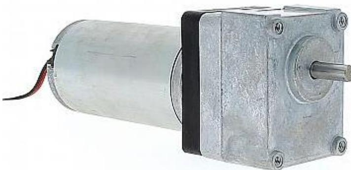
Boîte de vitesses à haute endurance pour une charge de travail continue dans toutes les situations position, à la température ambiante de -15 à 50 ° C, avec une charge de couple vers le haut à 3 Nm, charge constante. Fabriqué en Zamak moulé sous pression. Montage frontal par quatre M4 Trous filetés. Pignons droits avec pignons en acier et roues dentées, avec traitement thermique superficiel. Arbre de sortie. Tige en acier Ø6 mm, longueur utile 15 mm, avec un méplat.
