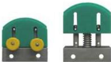
Cette série est conçue pour les applications demandant un encombrement réduit. Support, goupilles, ressorts et boulons en acier. Bloc coulissant en polyéthylène à haute densité moléculaire. Toutes les pièces métalliques sont fournies avec du zinc plaqué Course de 16mm.
