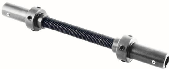
Les arbres flexibles AF sont utilisés pour coupler deux axes non alignés en maintenant la précision de la transmission. Le montage est simple sans aucun autre support. Embouts d'extrémités en INOX 303. Revêtement Rilsan pour des longueurs des 400mm.
