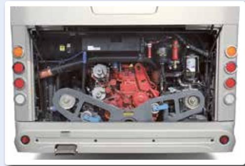
Tendeurs de courroies pour équipements auxiliaires.
